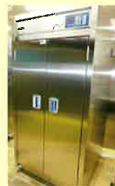
食器消毒保管庫 数種類の温度と時間設定ができます。
